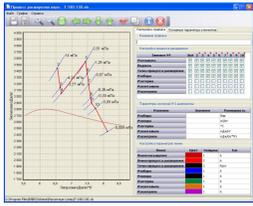
на базе заданной электрической и тепловой мощности турбоустановки. Программа рассчитывает около 40 типовых базовых элементов (котел, турбина, подогреватель поверхностного типа, конденсатор и т.д.). Результаты расчетов представляются в табличном и графическом виде с возможностью выполнения расчетов основных технико-экономических показателей.
